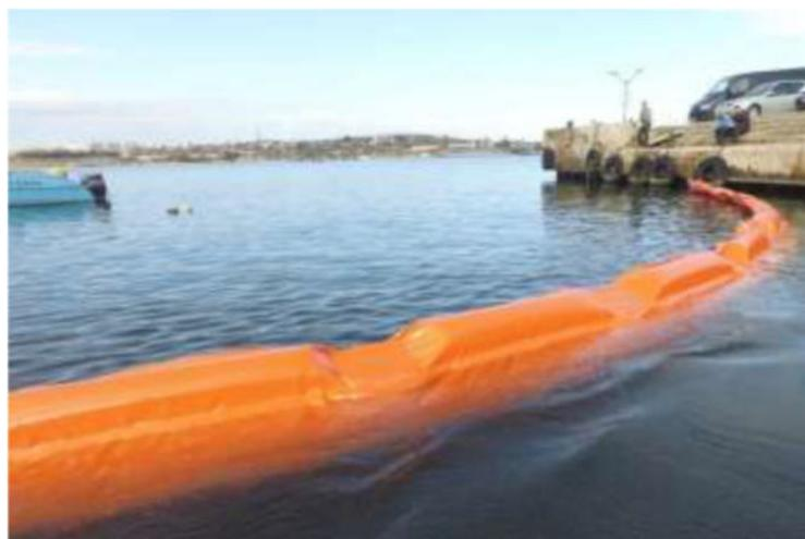
Рисунок 2.2.2.2 – Схема защиты причала от загрязнения
