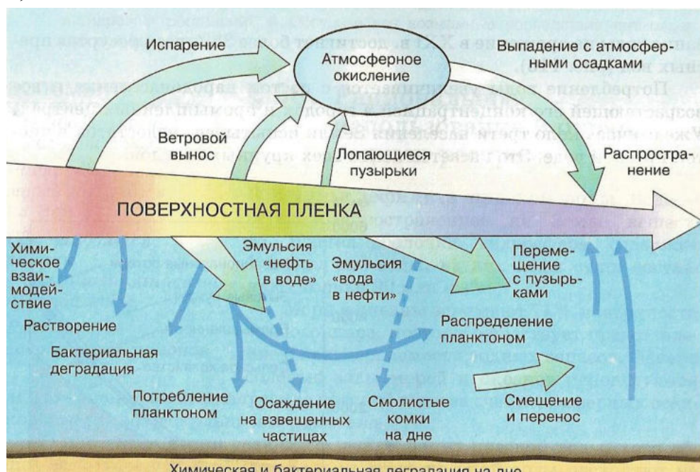
Рисунок 13.3.1.1 - Схема процессов распределения и разрушения нефтепродуктов, разлитых на воду
