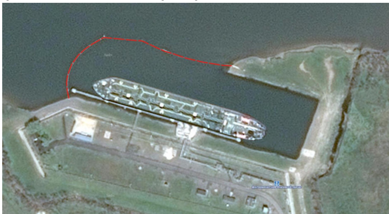
Рисунок 5.5.1- Схема постановки оперативных боновых заграждений при выполнении сливо-наливных операций
