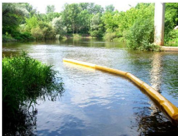
Рисунок 5.5.2- Общий вид боновых заграждений «БЗ-10/600 РРР»
